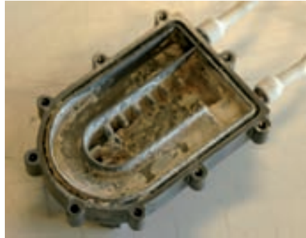
Verkalkt element van een willekeurig toestel
