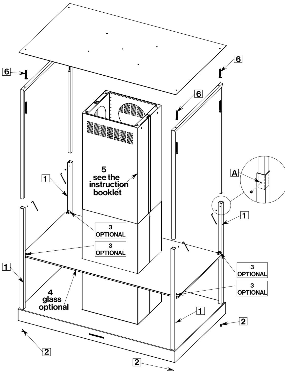
Per migliorare la tenuta del grano definire la posizione dei fori "A". Forare il traliccio superiore in corrispondenza della posizione "A" con punta Ø2,5 mm. Ripetere l'operazione per ciascun traliccio superiore.
