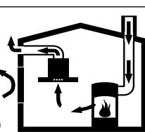
Ildsteder, hvis lufttilførsel sker fra indeluften, (f.eks. gas-, olie-, træ- eller kulfyrede varmeapparater, gennemstrømningsvandvarmere, vandvarmere) henter deres forbrændingsluft fra opstillingsrummet og fører røggassen ud gennem en røggaskanal(f.eks. skorsten) til det fri.
