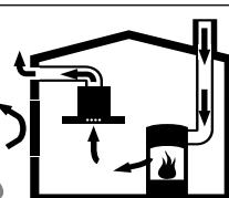
Zależne od powietrza w pomieszczeniu urządzenia spalające (np. grzejniki na gaz, olej, drewno lub węgiel, przepływowe podgrzewacze wody i inne podgrzewacze wody) pobierają powietrze do spalania z pomieszczenia, w którym się znajdują, a spalin odprowadzają przez układ wylotowy (np. komin) na zewnątrz.
