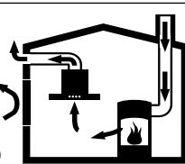
Eldstäder som är beroende av rumsluft (t.ex. värmearrapparater som drivs med gas, olja, ved eller kol, genomströmningsapparater, varmvattenberedare) tar sin förbränningluft ur det utrymme där enheten är installerad och leder ut avgaserna i det fria via en avgasanläggning (t.ex. skorsten).
