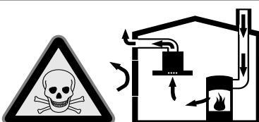
Raumluftabhängige Feuerstätten (z.B. gas-, öl-, holz- oder kohlebetriebene Heizgeräte, Durchlauferhitzer, Warmwasserbereiter) beziehen Verbrennungsluft aus dem Aufstellraum und führen die Abgase durch eine Abgasanlage (z.B. Kamin) ins Freie.
