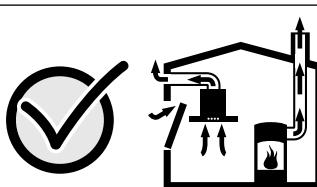
Ziehen Sie in jedem Fall den Rat des zuständigen Schornsteinfegermeisters hinzu, der den gesamten Lüftungsverbund des Hauses beurteilen kann und Ihnen die passende Maßnahme zur Belüftung vorschlägt.
