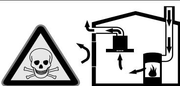
Huoneilmaa tarvitsevat tulisijat (esim. kaasu-, öljy-, puu- tai hiilikäytöiset lämmityslaitteet, läpivirtauskuumennin, vedenkuumennin) ottavat poistoilman huonetilasta ja johtavat poistoilman poistoilmalaitteen (esim. savutorven) kautta ulos. Tuuletin imkeele keittiöstä ja sen viereisistä huoneista ilmaa - tämä on korvattava riittävällä tuloilmallla - muutoin syntyy alipaine. Myrkylliset kaasut imetyisivät takaisin huoneisiin savutorvesta tai poistoilmakanavasta.
