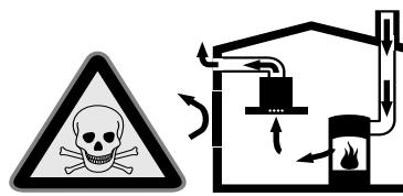
Ildsteder som er avhengig av romluft (f.eks. varmeapparater som drives med gass, olje eller kull, varmtvannsberedere) bruker forbrenningsluften fra oppstillingsrommet og leder avgassene gjennom et avgassanlegg (f.eks. pipe) i det fri.
