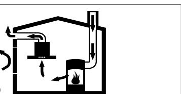
I focolari che dipendono dall'aria ambiente (peres. a gas, olio, legna o carbone, scaldabagno, caldaie elettriche) ricavano l'aria per la combustione dalla stanza ed eliminano i gas di scarico all'esterno attraverso un impianto (peres. camino).
