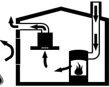
Vuurbronnen die de lucht in de ruimte verbruiken (bijv. apparaten die op gas, olie, hout of kolen worden gestookt, geisers, warmwateroestellen) trekken de verbrandingslucht uit de opstellingsruimte en voeren de gassen via een afvoer (bijv. schoorsteen) af naar buiten.
