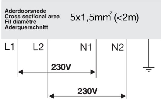
**De elektrische aansluiting wijzigen/Changing the electrical connection**
