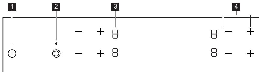
Gebruik de tiptoetsen om het apparaat te bedienen. De displays, indicatielampjes en geluiden tonen welke functies worden gebruikt.
