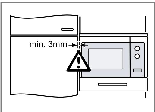
La distance par rapport aux appareils adjacents doit d'être d'au moins 3 mm.
