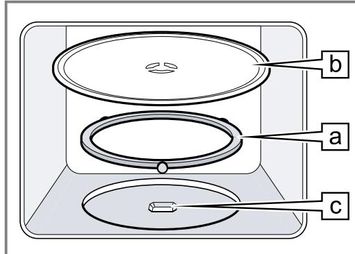
2. De draaischijf **b** in de aandrijving **c** in het midden van de bodem van de binnenuimte vergrendelen.
