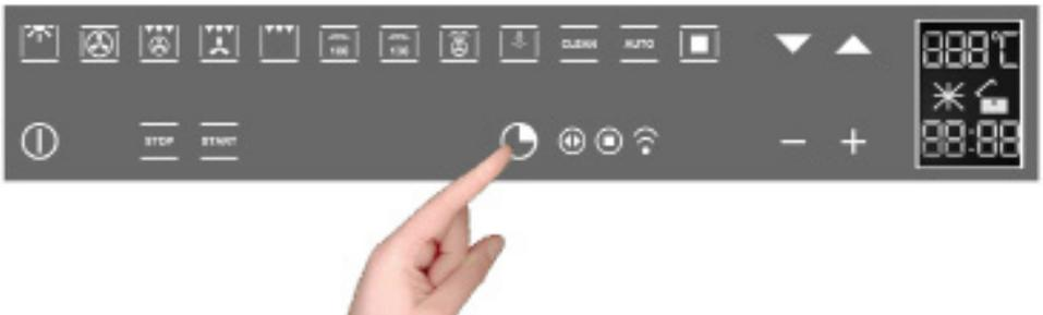
Der Ofen signalisiert den Anschluss an das Stromnetz mit einem zweifachen Signalton. Um die Systemuhrzeit einzustellen, betätigen Sie die Taste „TIMER FUNKTIONEN“ 3 Sekunden lang.
