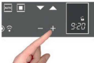
Stellen Sie die Uhrzeit mit den Tasten + und - ein: Während der Einstellung blinken die Trennpunkte. Die Uhrzeit wird erfasst, wenn die Punkte fix leuchten.
