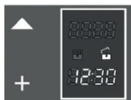
Una volta definita l'ora di fine cottura, il display visualizzerà ancora l'ora corrente, il simbolo "fine cottura" sarà acceso.
