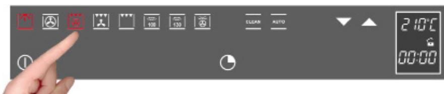
Il controllo propone una temperatura per ogni funzione tradizionale, è possibile in qualsiasi momento modificarla, ma se la ritenete idonea non occorre fare altro, il forno si attiverà da solo in pochi secondi!
