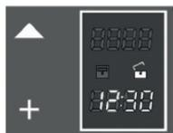
Una volta definito il tempo di cottura, il display visualizzerà ancora l'ora corrente, il simbolo "durata cottura" sarà acceso.
