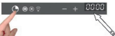
Toccare una volta il simbolo timer, si accenderà il simbolo relativo. Inoltre il display dell'orologio sostituirà l'indicazione dell'ora corrente.
