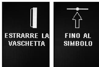
Una volta estratta parzialmente la vaschetta (guardare il simbolo della freccia sul lato sinistro o le due tacche sopra la caraffa), premere START dando il via allo svuotamento del circuito di produzione del vapore
