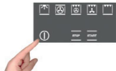
Der Ofen wird durch Drücken des Symbols lt. Abbildung eingeschaltet.
