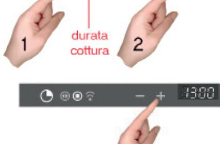
Definite adesso l'ora di fine cottura : il controllo normalmente somma all'ora attuale il tempo di cottura e la propone come ora di fine cottura, nel nostro caso proporrà le ore 10:30 (8:30+2:00).
