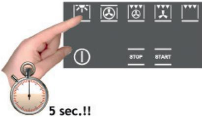
Um die Vorfühmodalität zu deaktivieren, berühren Sie fünf Sekunden lang das Licht-Symbol: Die Steuerung geht in die normale Betriebsart über und kann nun eingeschaltet werden.
