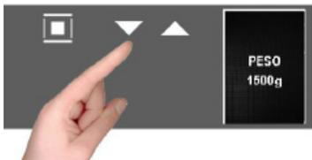
Es wird die Seite des Gewichtes angezeigt. Mit den Tasten ▼ ▲ einen der voreingestellten Werte wählen und diese Wahl dann mit der Taste
