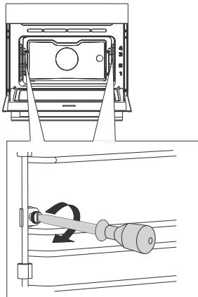
**1** Schraube lösen. Verwenden Sie einen Schraubendreher.
