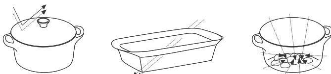
Lorsque les aliments sont exposés aux micro-ondes, les molécules se mettent à bouger rapidement, générant ainsi de la chaleur.
