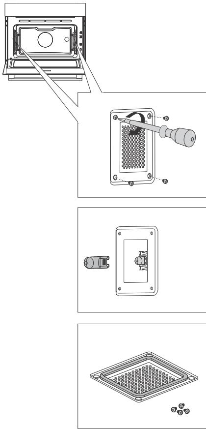
**1** Lösen Sie die vier Schrauben. Entfernen Sie die Abdeckung und das Glas.
