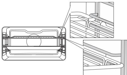
Führen Sie bei Drahtführungen immer den Drahtrost (Gitter) und die Backbleche in den Schlitz zwischen dem oberen und unteren Teil jeder Führungsebene ein.
