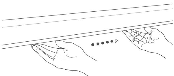
Une autre façon de déplacer le faisceau lumineux est de tenir votre main sous le capteur où vous voulez déplacer le faisceau lumineux. Le faisceau lumineux se dirige alors vers votre main.
