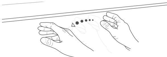
2. Un faisceau plus étroit est activé en tenant votre main sous la bande de détection pendant plus d'une seconde. Le faisceau lumineux ne sera activé qu'à l'endroit où se trouve votre main.
