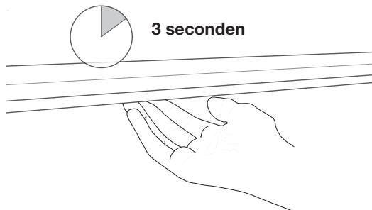
Door je hand onder de sensor door te halen “scroll” je door het beschikbare kleurenpaljet. Je kunt vooruit en achteruit scrollen door de hand ofwel van links naar rechts ofwel van rechts naar links onder de sensor te swipen.
