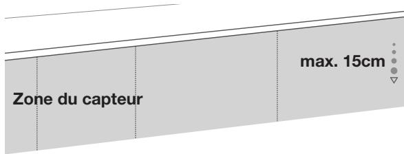
Pour tous les mouvements effectués sous les 15 cm, le capteur ne réagit pas.
