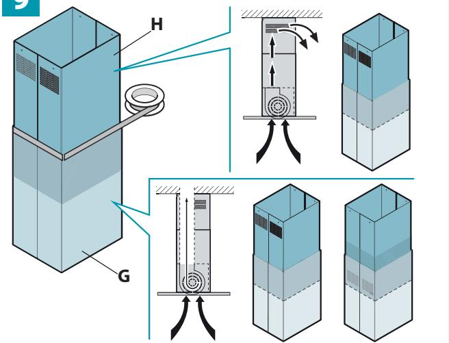
IT - Configurazione a soffitto (10); configurazione a controsoffitto 11.
