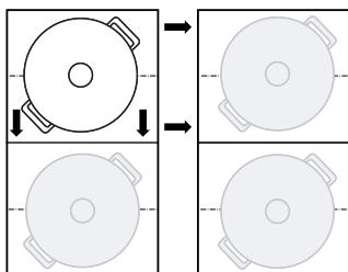
La stoviglia viene riconosciuta e sull'indicatore della nuova area di cottura lampeggiano in modo alternato il livello di potenza precedentemente selezionato e .
