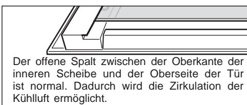
Der offene Spalt zwischen der Oberkante der inneren Scheibe und der Oberseite der Tür ist normal. Dadurch wird die Zirkulation der Kühlluft ermöglicht.
