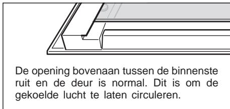
De opening bovenaan tussen de binnenste ruit en de deur is normal. Dit is om de gekoelde lucht te laten circuleren.
