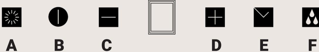
**A:** Taste Licht AN/AUS: bei Berührung der Taste schalten sich die Lichter der Dunstabzughäube an bzw. aus.
