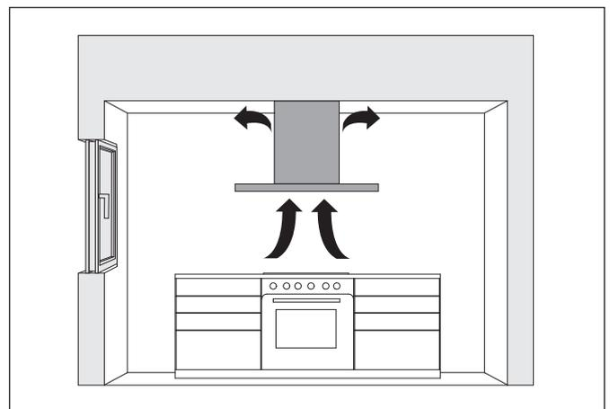
Die Filter-Füllung im Umluftfilter neutralisiert die vorhandenen Geruchsanteile. Die geruchsfreie, gereinigte Raumluft wird dem Raum wieder zugeführt. Durch Frischluftzufuhr kann die Luftfeuchtigkeit im Raum reduziert werden.
