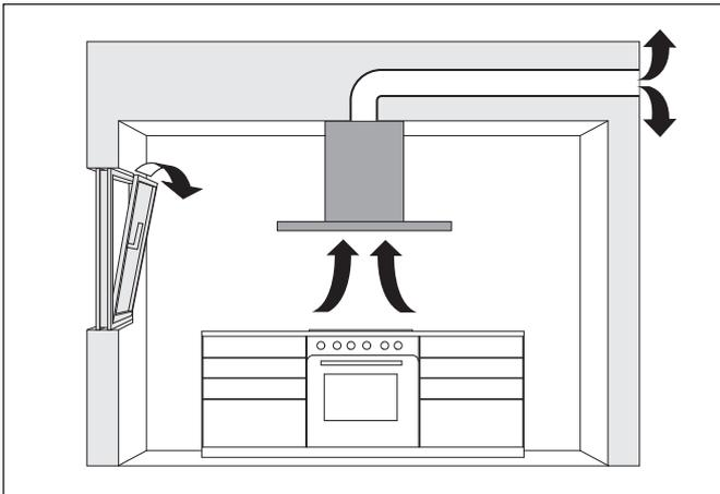
Die gereinigte Raumluft wird über die Baukonstruktion (z. B. Rohre, Kamin) nach außen ins Freie geleitet.
