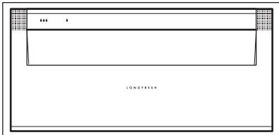
Les bacs portant le symbole d'une goutte d'eau : ΔΔΔ et δ peuvent s'utiliser suivant les conditions de conservation souhaitées indépendamment l'un de l'autre avec un niveau d'humidité plus ou moins élevé.
