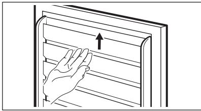
3. Schieben Sie die anderen Schienen nach oben, um sie zu entfernen (sie bilden ein Teil).
